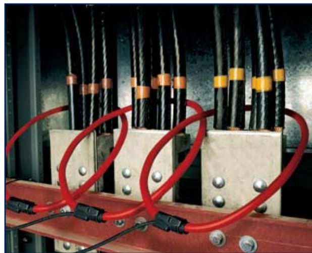
Flexibles para hacer mediciones fácilmente donde los instrumentos de pinzas estándar no tienen acceso.
